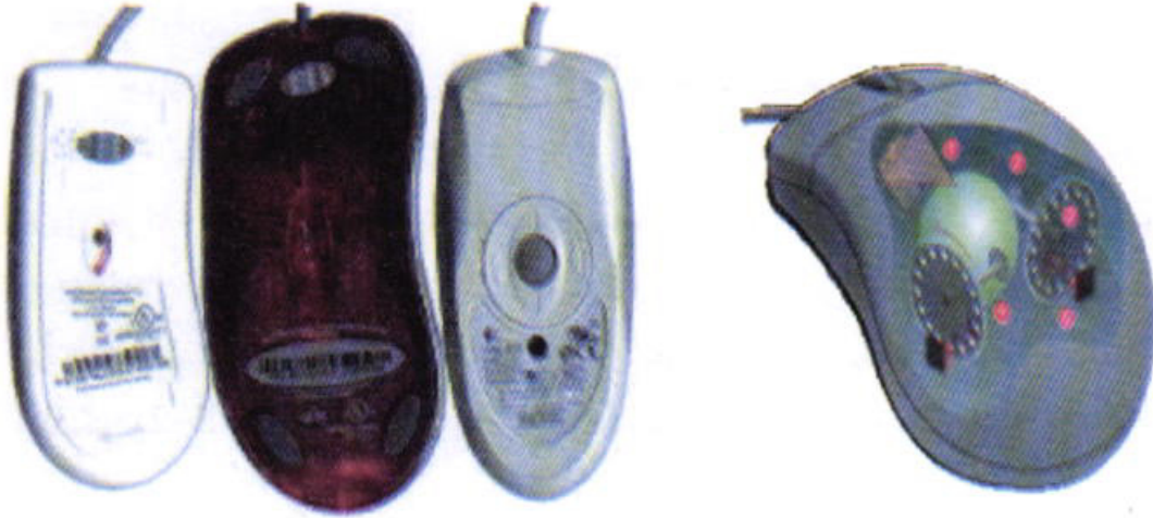
a- التركيب الداخلي لماوس ذو الكرة b- من اليمين: ماوس ذو الكرة، ماوس ضوئي، ماوس ليزري
