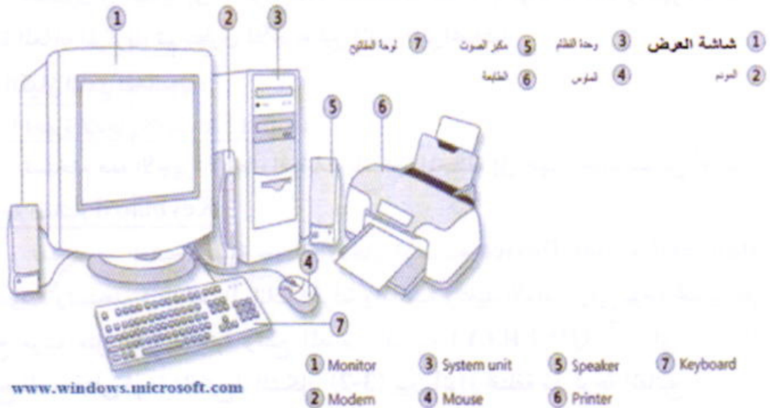
الشكل (1-2) يبين الأجزاء والملحقات الرئيسية للحاسوب المكتبي
